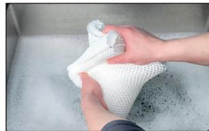
2. 用干净的温水反复冲洗AW200蒸发网，直到不再产生泡沫。
