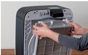
3. 拉出水槽, 拆下轮毂及3D蒸发网。
