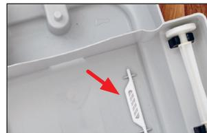
5. 将滚轮装回到水盆内，按相反顺序组装好设备。
