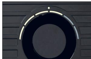
2. 短暂地再按压控制旋钮一次关闭自动模式下运行的设备。
