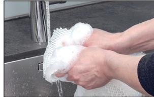
2. 继续用干净的温水冲洗AH700蒸发芯，直到不再产生泡沫。
