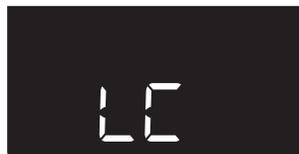
Wird der Leistungsregler bedient, nachdem die LOCK-Funktion über die BONECO-App aktiviert wurde, blinken die LEDs und das Display 3× schnell hintereinander. Ist das Gerät über die BONECO-App ausgeschaltet worden, blinkt im Display 3× der Hinweis „LC“.
