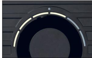
3. 短暂地按压控制旋钮一次退出手动模式切换为自动模式。
