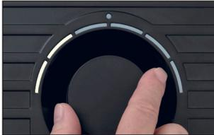
选择的性能水平是由控制旋钮上的发光的二极管的数量表示。
