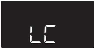
如果通过BONECO应用程序设置儿童锁功能后操作控制旋钮，led灯和显示屏会连续快速闪烁3次。如果设备通过BONECO APP关闭此功能时，“LC”符号将在显示屏上闪烁3次。
