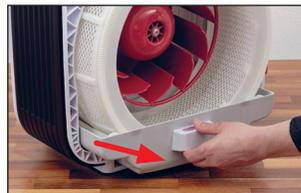
4. Entleeren Sie die Wasserwanne sowie den Wassertank und entnehmen Sie den A7017 Ionic Silver Stick®.
