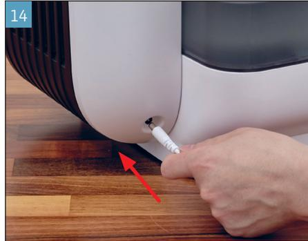
Verbinden Sie die Stromversorgung zuerst mit dem BONECO H700 und dann mit der Steckdose.
