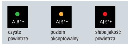
Aktualna jakość powietrza może zostać zmierzona przez czujnik dopiero po upływie ok. jednej minuty od włączenia urządzenia. W tym czasie urządzenie pracuje na stopniu «L».
