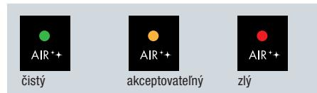
Pri zapnutí prístroja trvá približne minútu, kým senzor odmeria aktuálnu kvalitu vzduchu. V priebehu tohto času beží prístroj na stupni „L“.
