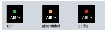
Når apparatet slås på, tar det ca. et minutt til sensoren har målt den gjeldende luftkvaliteten. I dette tidsrommet går apparatet på trinn "L".
