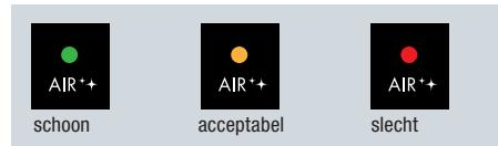
Na het inschakelen van het apparaat duurt het ongeveer één minuut voordat de sensor de luchtkwaliteit heeft gemeten. Gedurende deze tijd werkt het apparaat in de stand "L".
