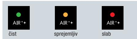
Senzor za meritev trenutne kakovosti zraka po vklopu naprave potrebuje približno eno minuto. Naprava v tem času deluje s stopnjo „L“.
