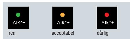
Når apparatet tændes, varer det cirka et minut, før sensoren har målt den aktuelle luftkvalitet. I denne periode kører apparatet i trin "L".
