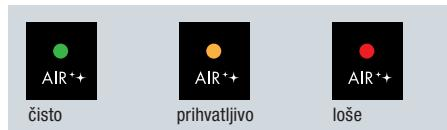
Nakon uključivanja uređaja senzoru je potrebno oko jednu minutu da izmjeri trenutačnu kvalitetu zraka. Za to vrijeme uređaj radi na stupnju «L».
