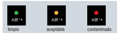
Tras encender el aparato, el sensor tarda unos minutos en medir la calidad del aire actual. Transcurrido ese tiempo, el aparato pasa a la potencia «L».
